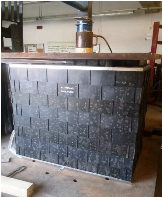
Foto 2: Detalle ensayo compresión Axial
