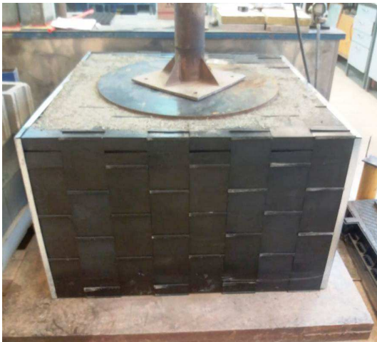
Foto 4: Detalle ensayo compresión lateral
