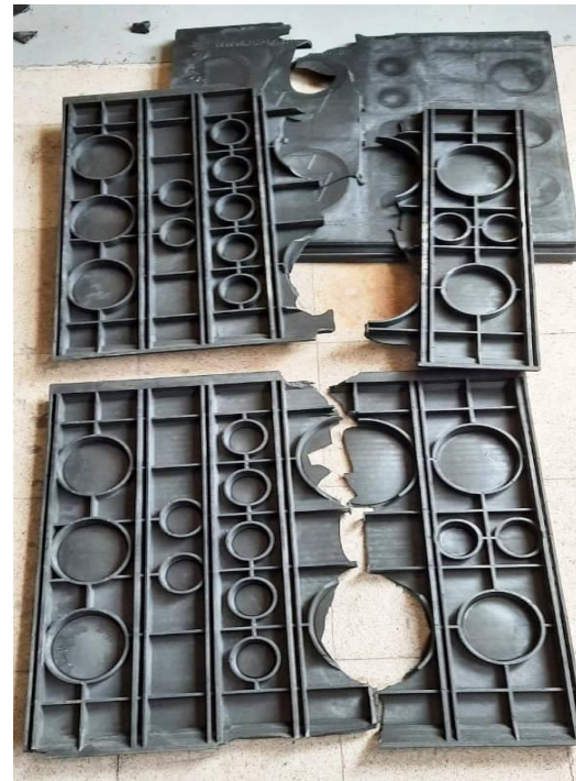
Foto N° 4: Detalle del tipo de falla en cámara de paso eléctrica tipo C 600x600 mm.
