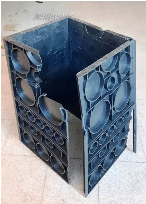
Foto N° 3: Detalle del tipo de falla en cámara de paso eléctrica tipo B 400x400 mm.
